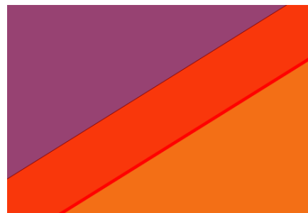
Exemple de superposition de deux polygones (échelle 40 000:1). Le recouvrement est de l'ordre du micromètre.
